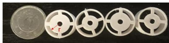
Fig.2 試作したマイクロロボット流出口の写真
