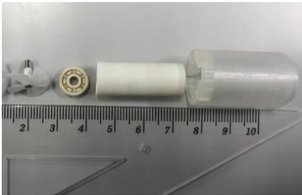
Fig.4 試作した部品図
